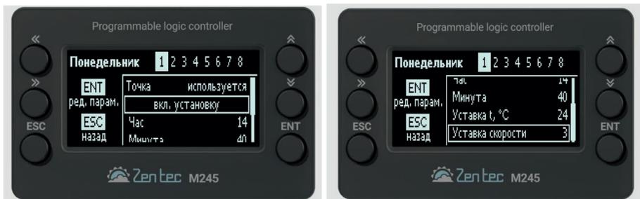
В подменю действия «1» указываем, что параметр «Точка» используется, выбираем, в каком состоянии должна быть установка (включиться или выключиться), указываем время, температуру уставки и требуемую скорость.
