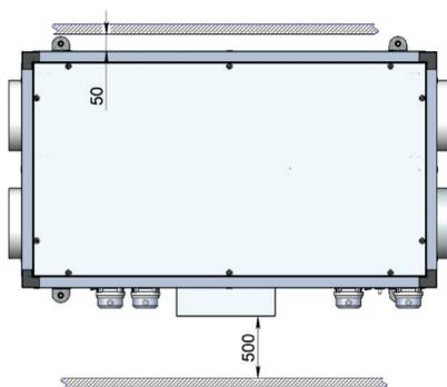
6.5 Обслуживание основных элементов установки (фильтры, вентиляторы, нагреватель, рекуператор) осуществляется снизу. Поэтому с нижней стороны необходимо предусмотреть возможность открытия сервисных дверей и выем фильтров. Сервисные двери выполнены съемными и закреплены винтовыми фиксаторами-барашками. На дверях установлены ручки, которые в случае необходимости могут быть удалены.
