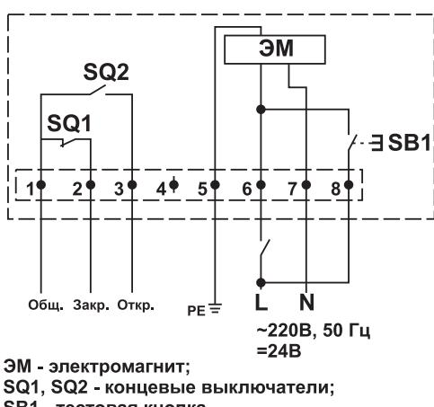
Рисунок 6.1 – Схема подключения электромагнитного (ЭМ) привода
