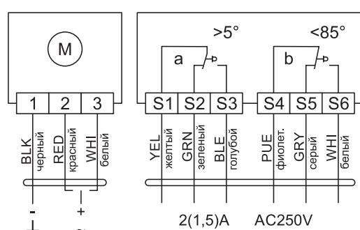
Рисунок 6.2 – Схемы подключения реверсивных (Р) приводов
